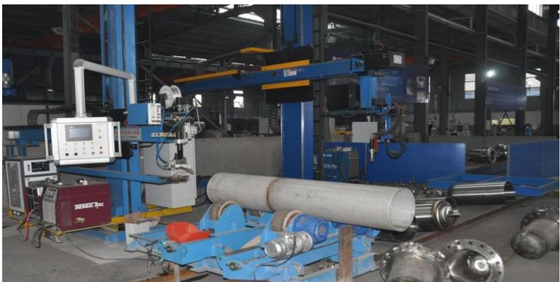
➤ Оборудование для автоматической сварки
